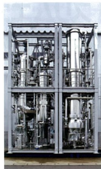
SRS—液晶パネルの製造工程で使用されている剥離液を再生する装置
